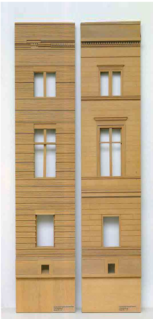
Maquette trame façade nouvelle (gauche) / ancienne (droite)
