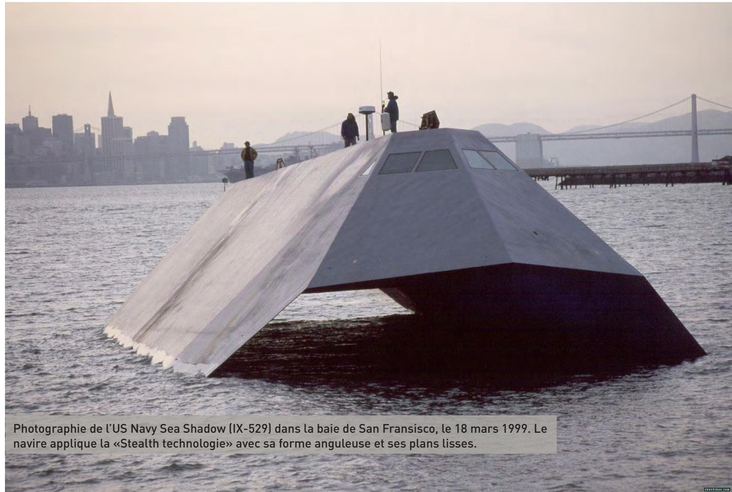
Photographie de l'US Navy Sea Shadow (IX-529) dans la baie de San Francisco, le 18 mars 1999. Le navire applique la «Stealth technologie» avec sa forme anguleuse et ses plans lisses.
