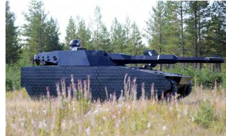
Photographie d'un CV90, un véhicule de combat de l'infanterie suédoise, recouvert des panneaux Adaptiv. Photographie appartenant à BAE Systems.
